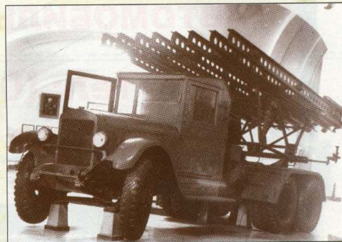
Один из ранних образцов гвардейского миномета БМ-13 на шасси ЗИС-6 стал экспонатом С.-Петербургского музея артиллерии и инженерных войск (фото автора)
