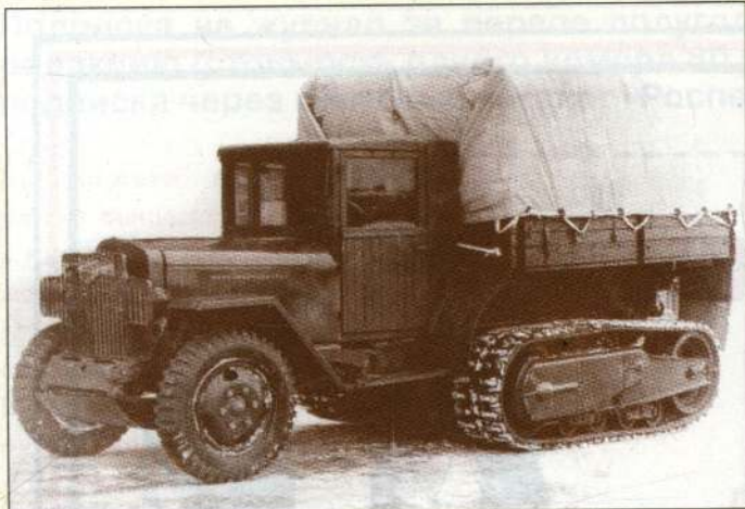
Усовершенствованный полугусеничный ЗИС-42М образца 1942 г. (фото с разрешения Е.И. Прочко)
