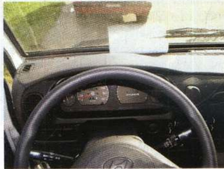
Обод руля закрывает часть приборной панели
