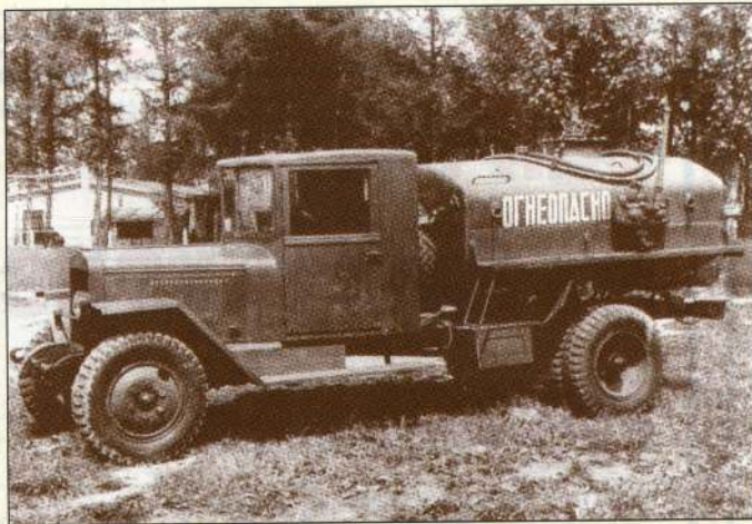
Самый распространенный топливозаправщик ВЗ-43 использовался для заправки танков (фото с разрешения Е.И. Прочко)
