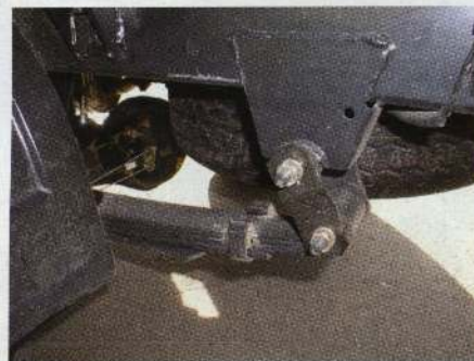
Задний мост имеет подвеску на малолистовых рессорах
