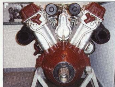
Виден картер к которому крепятся два блока
