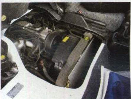
Доступ к двигателю через поднятое пассажирское сиденье
