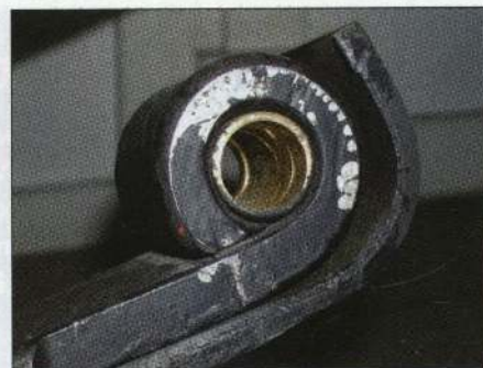
Заделка рессоры «тяжелого» типа с втулкой
