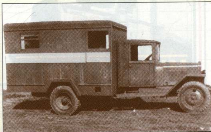
Походные мастерские АПРИН на шасси ЗИС-5 начали выпускаться с конца 1941 г. (фото с разрешения Е.И. Прочко)
