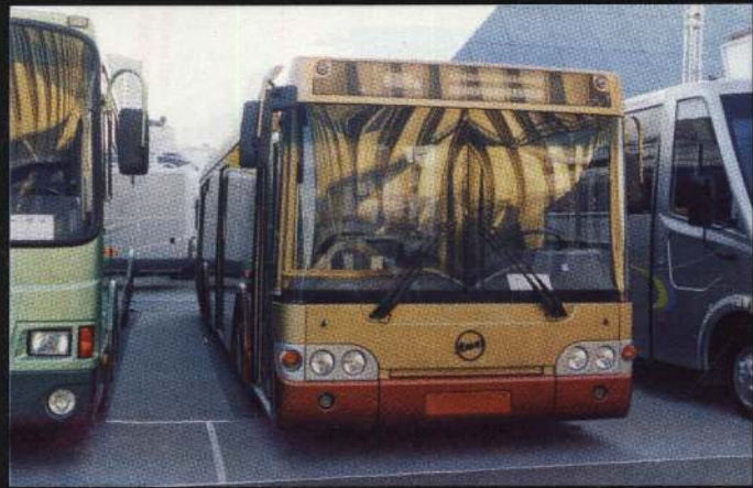
ЛиАЗ-5292.57 работает на сжатом газе
