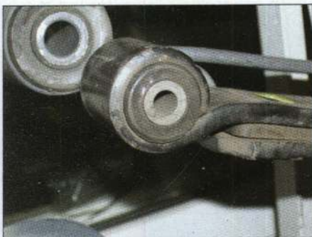
Заделка рессоры «легкого» типа с резиновыми втулками, или сайлент-блоками
