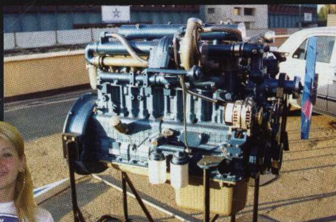
ММЗ D-260 Euro-3 с впрыском Common Rail от Bosch: «Зиловский размерчик», только ставить не на что
