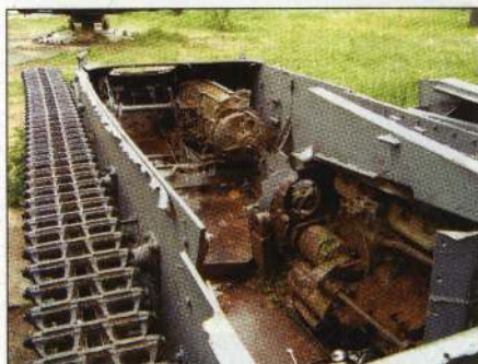
В любом немецком танке сзади бензиновый двигатель, спереди – коробка передач и место водителя
