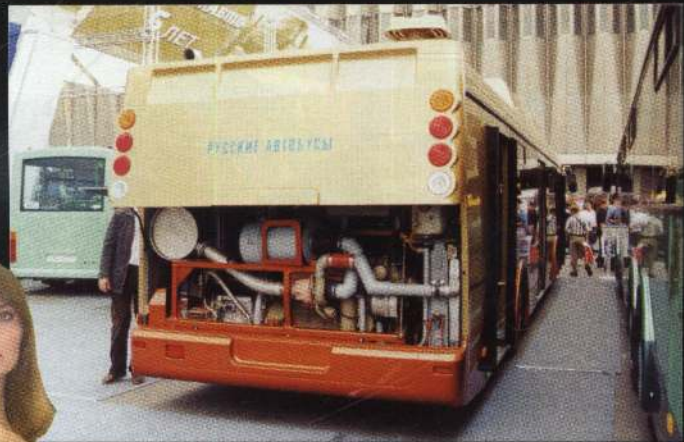
Двигатель Cummins CG-250 с искровым зажиганием автобуса ЛиАЗ-5292.57
