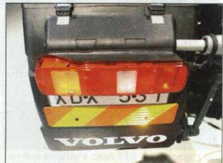
Светоотражающий щиток на брызговике - полезный элемент
