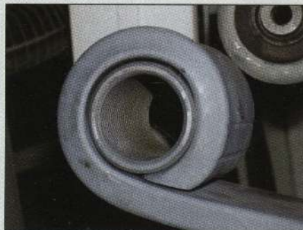
Резьбовые втулки могут использоваться в обоих концах рессоры
