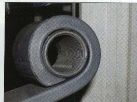
Резьбовые втулки могут использоваться в обоих концах рессоры
