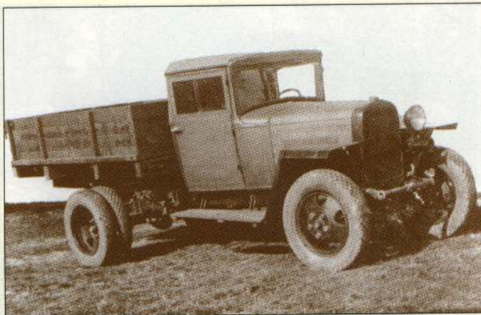
ГАЗ-ММ военного времени: с деревянными дверями, одной фарой и гнутыми крыльями
