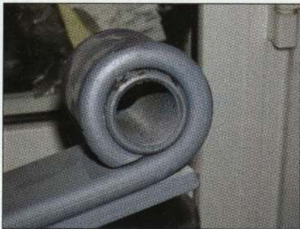
При заделке «тяжелого» типа некоторые производители используют резьбовые втулки; палец из них вывинчивают
