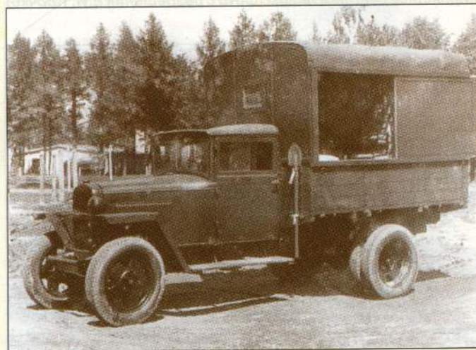
Передвижная электростанция на шасси ГАЗ-ММ (фото с разрешения Е.И. Прочко)
