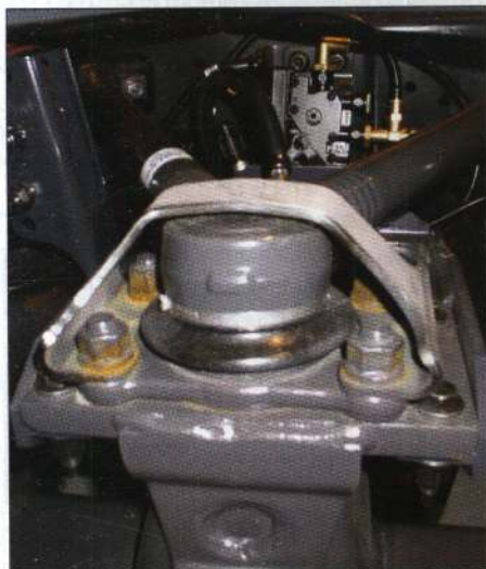
На грузовиках 6x2 шар V-образной тяги страхуют скобой, предотвращающей потерю моста во время аварии
